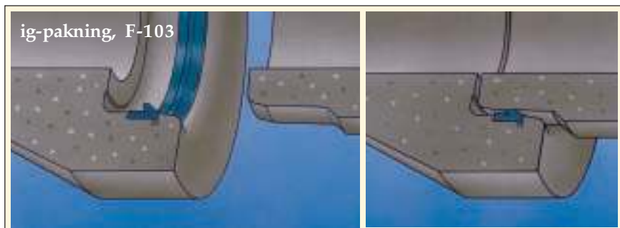
Snit i betonrørssamling med ig-pakning, henholdsvis før og efter samling.
