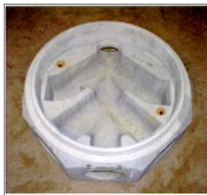
Eksempel på specialbrøndbund. Mulighed for vilkårlig vinkeldrejning for tilslutninger sikrer rørstrækninger uden bøjninger.
