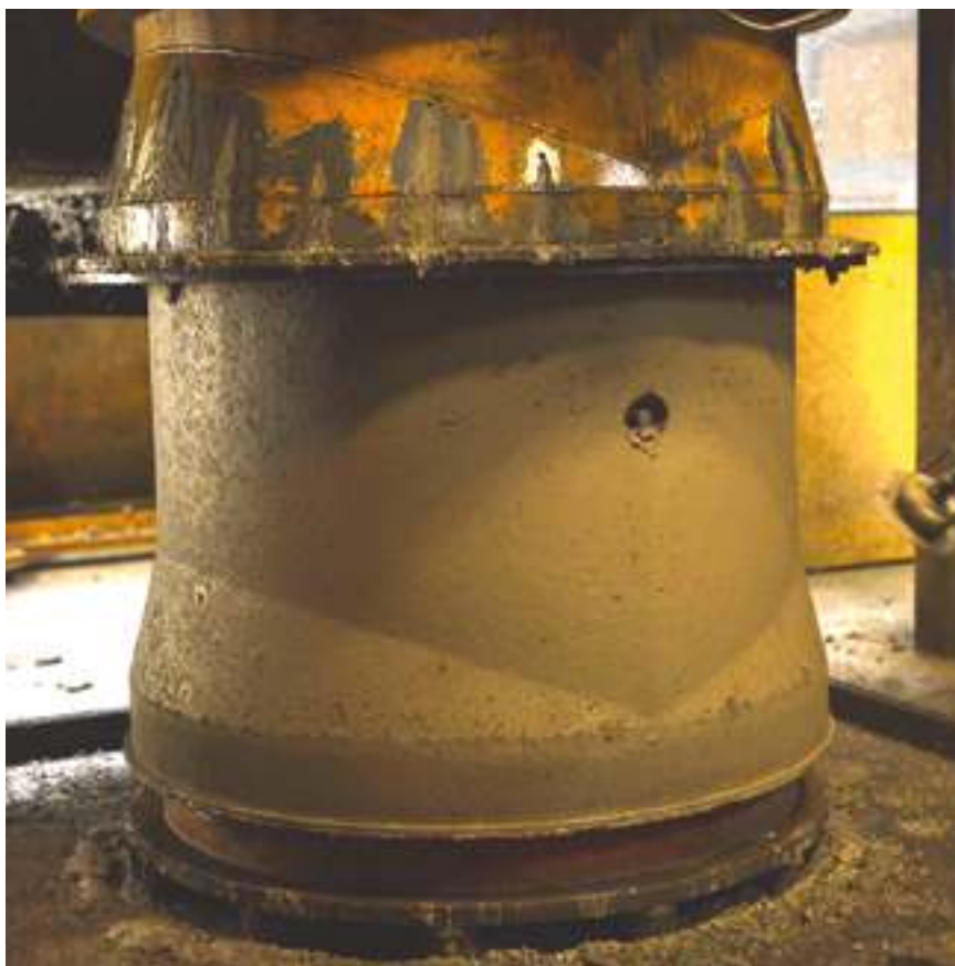
Umiddelbart efter støbning fjernes støbeformen fra det allerede formstabile betonrør
