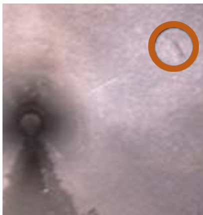
Eksempel på en blære i et DN800 mm betonrør. Blæren er større end tilladeligt, men har ingen effekt på rørets funktion
