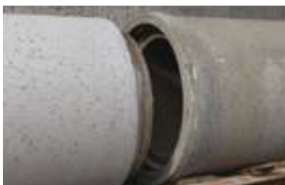
Eksempel på tørstøbt beton
