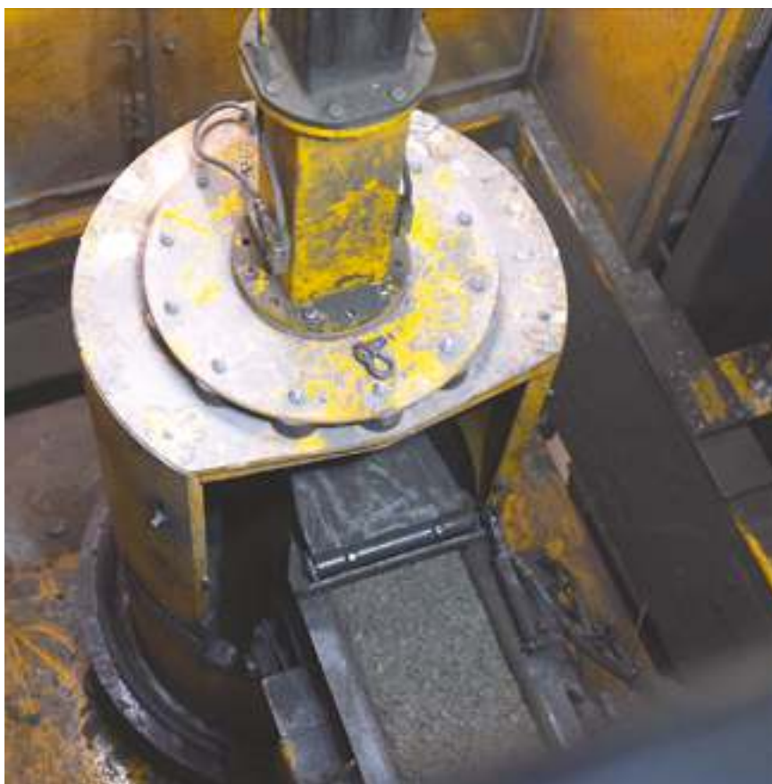
Støbeform til betonrør. Betonen tilsættes hvorefter den komprimeres ved hjælp af vibration og tryk
