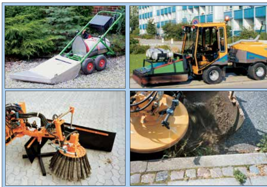
Figur 4.14. Øverst ses to udgaver af ukrudtsbrænderen, og nederst en stålbørste. Overdreven brug af stålbørsten frarådes, da den slider meget på belægningen.
