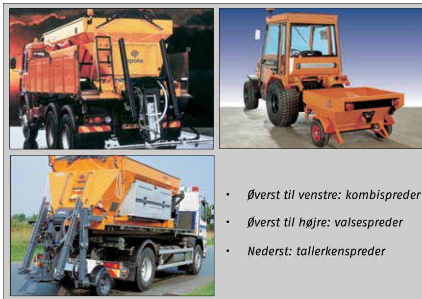
Figur 4.19. Salt kan principielt spredes på tre måder, som tørt salt, fugtet salt eller som saltopløsning. Øverst til højre ses en mindre valespredere til tørt salt, øverst til venstre en kombispreader der kan sprede både fugtet salt og en saltopløsning og nederst en traditionel tallerkenspredere til både tørt og fugtet salt.
