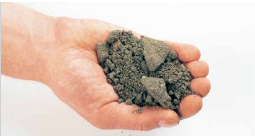
Figur 3.16. Cementbundet stabilt grus lige efter iblanding af cement.
