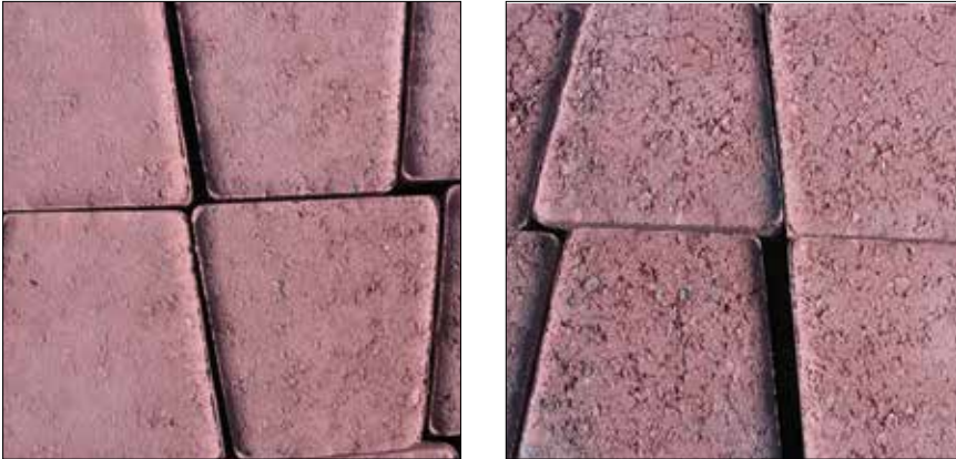
Figur 2.44. Til venstre ses en sten med meget lukket overflade og til højre en sten med meget åben overflade. Rent teknisk er stenene lige gode, men i et enkelt parti sten må der ikke være så stor variation i udseendet.
