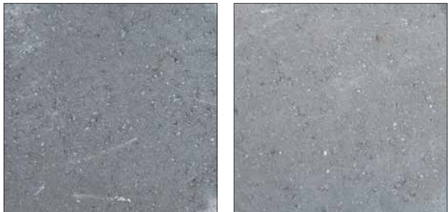
Figur 2.49. Viser 2 ens sorte fliser, der er 8 år gamle. Flisen til venstre har været tildækket, mens den til højre har ligget frit og derfor er blevet bleget af sol med videre.
