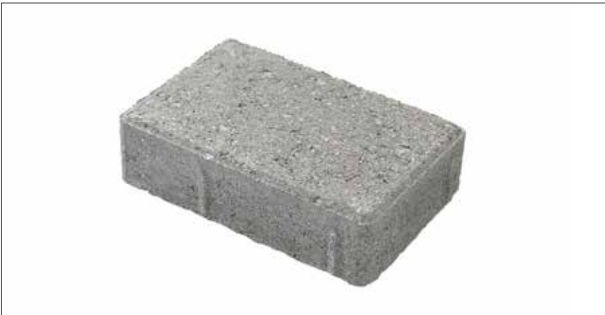
Figur 2.26. Betonsten og -fliser har normalt ca. 1,5 mm fugeknaster. Fugeknaster er udviklet for at muliggøre transport ved maskinlægning og har ingen funktion med hensyn til at opnå den rette fugebredde.
