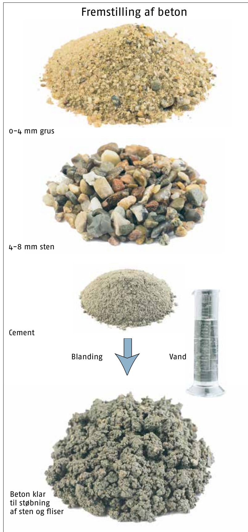
Figur 2.40. Betonbelægninger fremstilles af sand, sten, cement og vand. Disse bestanddele blandes til beton, som støbes og vibreres i forme, til betonsten eller -fliser. Se desuden afsnit "2.5 Fremstilling af betonsten og -fliser".
