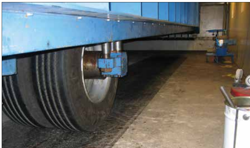
Figur 3.8. "Heavy vehicle simulator" som benyttes til test af belægninger. Midt i køretøjet er der monteret et hjul der kører frem og tilbage. Hjulet belastes, og der kan således hurtigt simulere mange lastbiler sammenlignet med den tid det ville tage hvis den "almindelige trafik" skulle benyttes.
