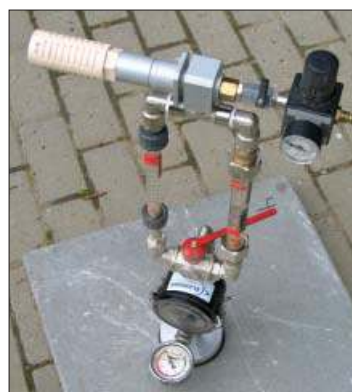
Udstyr til måling af porøsiteten af betonfliser.
