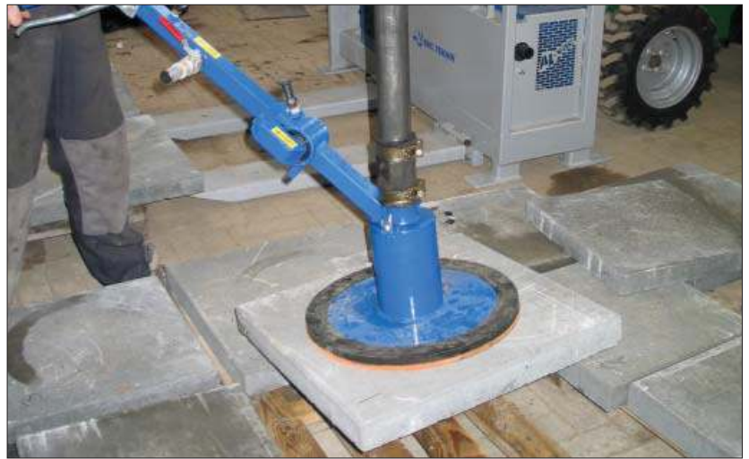
Før et maskinkøb bør der testes med en flise med et eller 2 stk. 6 mm huller i. Her en 50 x 50 x 5 cm flise med 2 stk. 6 mm huller.
