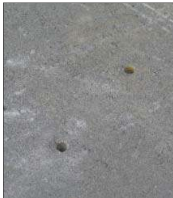
Har vakuumløfteren tilstrækkelig kapacitet skal den kunne løfte en 50 x 50 x 5 cm flise med 2 stk. 6 mm borede huller eller en fortovsflise (80 x 62,5 x 7 cm) med 1 stk. 6 mm hul.
