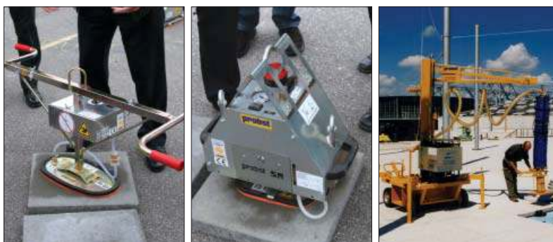
Yderst tv. en lille batteridrevet vakuumløfter. I midten en vakuumløfter der monteres på f.eks. en gravemaskine og drives af dennes hydraulik. Yderst th. en selvstændig vakuumløfter med stor luftflow. Det er kun de sidste to typer der kan være anvendelige til betonfliser.
