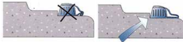
Her vil pakningen ikke rulle korrekt. Risiko for muffesprængning.
